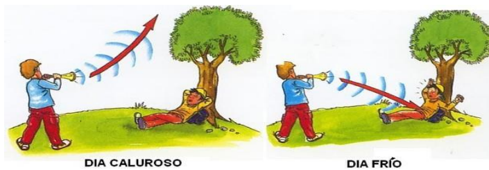
Illustration 1 Muestra la dirección que toma la onda sonora dependiendo de la temperatura
